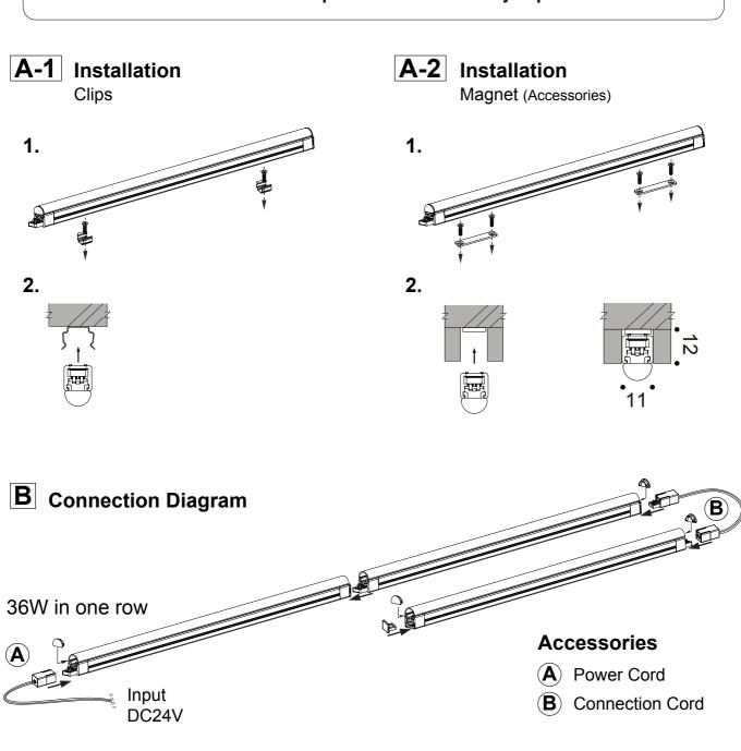
100mm: 1W / 300mm: 4W 600mm: 8W / 900mm: 12W 1200mm: 16W
